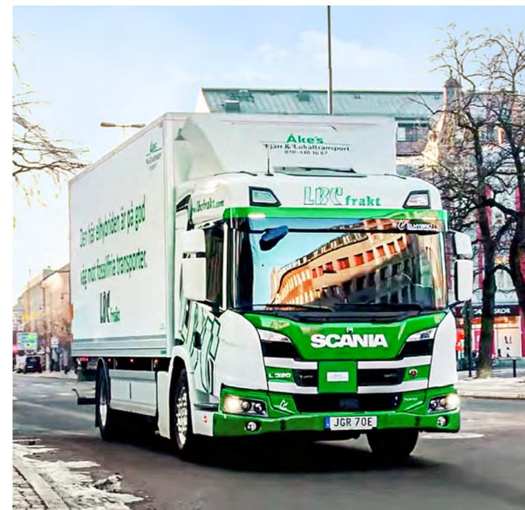
Saubere Lieferung: Der schwedische Konzern LBC Frakt AB setzt bei der Umstellung auf fossilfreie Transporte auf einen Plug-in-Hybrid-Lkw von Scania. Er wird mit Strom aus der firmeneigenen Solaranlage oder mit organischem Diesel betrieben.
